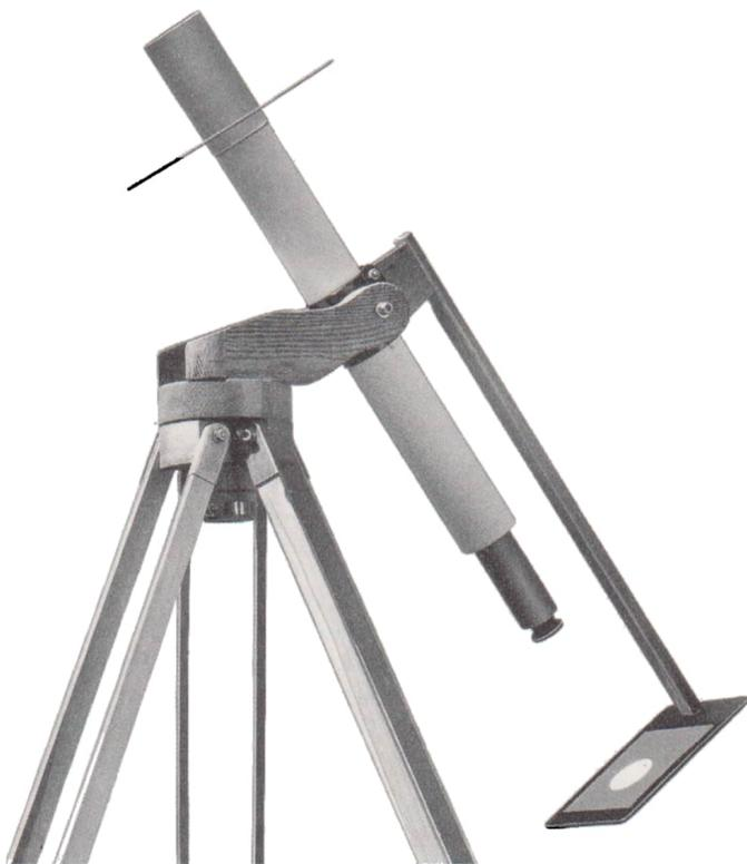
106 *Das fertige Selbstbaufernrohr mit dem Sonnenprojektionsschirm*
