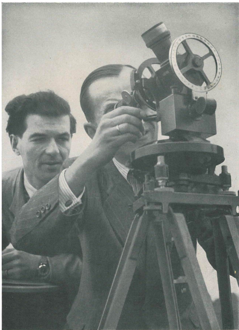
Am Theodolit wird der Flug des Pilotballons verfolgt
