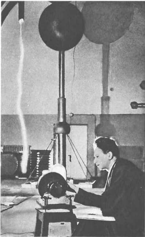
Abb. 13. Künstlicher Blitz im Laboratorium des Energetischen Instituts. Prof. I. S. Stekolnikow, Doktor der technischen Wissenschaften, prüft an einem Modell eine Blitzschutzvorrichtung für Höchstspannungsleitungen.
