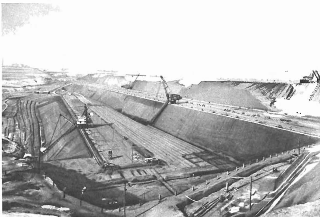
Abb. 19. Braunkohlentagebau. Die Kohle wird in mehreren Horizonten abgebaut. Der Abbau erfolgt maschinell.
