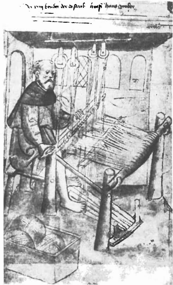
Abb. 24. Webstuhl. Der Fußtritt zur Fachbildung, der in dieser Abbildung zum erstenmal überliefert ist, bedeutete einen großen technischen Fortschritt. Vorher mußte der Webstuhl von zwei Webern bedient werden. (Um 1389, Nürnberger Malerei aus dem Mendelschen Hausbuch.)
