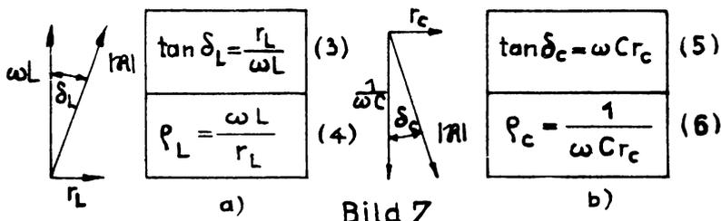
Beim Reihenschwingungskreis können die Verlustwiderstände zu einem Kreisverlustwiderstand zusammengefaßt werden.
