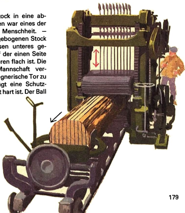
In Sägewerken wird Rundholz mit Gattersägen zu Balken, Kanthölzern, Bohlen oder Brettern aufgeschnitten
