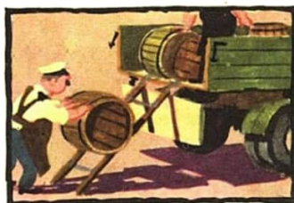
Je länger die geneigte Ebene im Verhältnis zu ihrer Höhe ist, desto weniger Kraft muß aufgewendet werden
