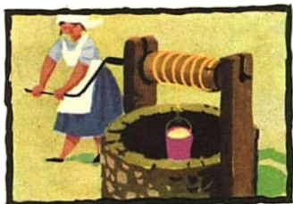
Bei der Seilwinde hilft die an einer Welle befestigte Kurbel Kraft »sparen«
