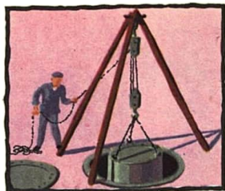
Feste und lose Rollen sind im Flaschenzug so miteinander verbunden, daß nur eine kleine Kraft notwendig ist, um große Lasten zu heben
