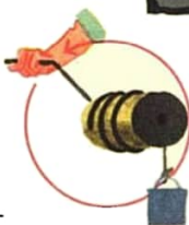
Bei der Seilwinde hilft die an einer Welle befestigte Kurbel Kraft »sparen«
