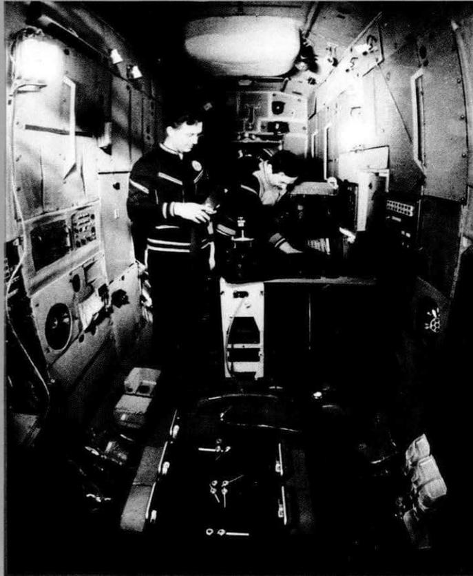
Kassettenwechsel der MKF 6 M im Simulator: Waleri Bykowski verfügt bereits über praktische Erfahrungen mit der Multispektralkamera. «Wir trafen uns nach dem Flug von Sojus 22 in Jena mit den Physikern, Konstrukteuren und Mechanikern, die die MKF 6 gebaut haben. Dabei konnten wir eine Reihe Hinweise für eine erhöhte Funktionstüchtigkeit der Kamera in der Schwerelosigkeit geben. Wir haben nun gesehen, daß die MKF 6 M eine stark verbesserte Weiterentwicklung ist.»
