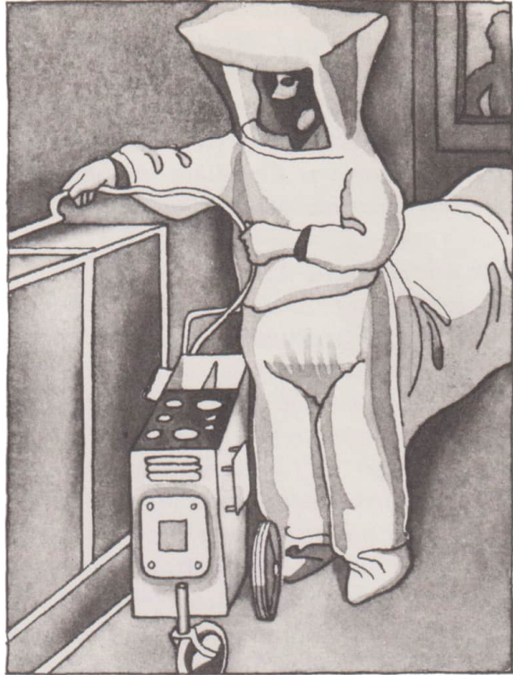
Schutzanzug für das Arbeiten mit pulverförmigen radioaktiven Stoffen
