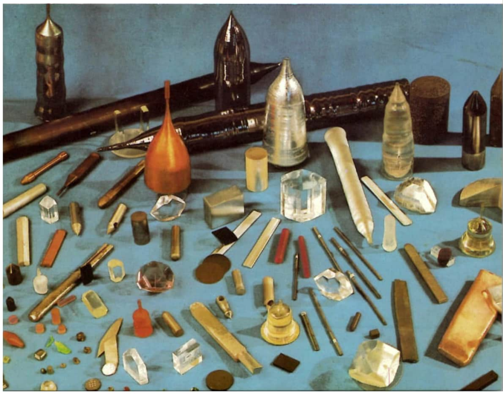
Tafeln 72 und 73 (↑ 6.4.2.1.) 1 Kristallherstellung mit Hilfe des Schwebezonenvorgangs; Aufheizung eines Siliciumstabs mit einer hochfrequenzgespeisten Spule in einem schmalen Bereich – 2 Blick auf einen wachsenden Siliciumeinkristall – 3 Auswahl synthetischer Einkristalle, die hauptsächlich nach dem Czochralskiverfahren in dem Spezialbetrieb für einkristalline Werkstoffe „Cristalec“ des Forschungszentrums CNRS Grenoble hergestellt worden sind; oben links Halbleiterkristalle von Germanium und Silicium, darunter bzw. rechts Einkristalle verschiedener Metalle, in der Mitte rote Stäbe für Rubinlaser, links unten schön gefärbte künstliche Halbedelsteine, unten rechts Einkristalle magnetischer Materialien
