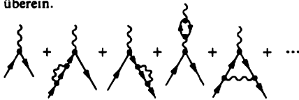
Abb. 3.2.4-5 Beiträge zum Elektron-Photon-Vertex
