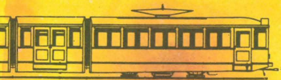
Gelenktriebwagen von 1929, sozusagen ein Vorläufer der heutigen Tatra-Gelenkwagen, aber mit schwebendem Mittelteil
