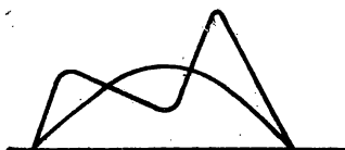
Bild 37 Sinuskurve und verzerrte Kurve
