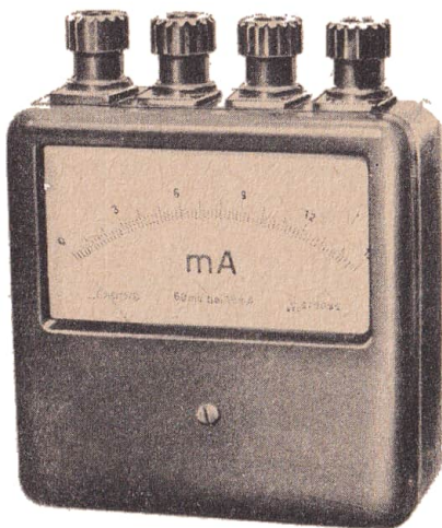
Bild 33 Praktische Ausführung eines Vielfachstrommessers
