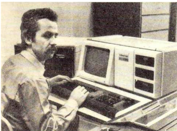
a) Entwurfsarbeitsplatz zur Optikentwicklung mit Kopplung zum A 6402 und Datenaustausch zum ESER
