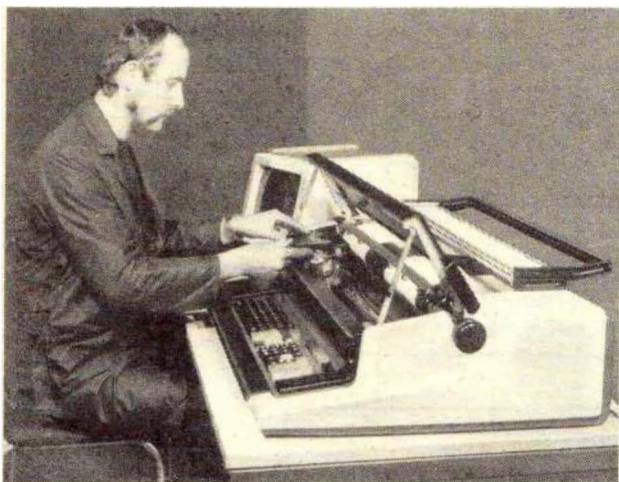
Das Anordnen des Farbbandes in einer Kassette ermöglicht einen schnellen und sauberen Wechsel
