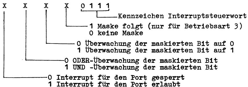
Arbeitet der Schaltkreis in der Betriebsart 3 (bitweise E/A), so kann im Anschluß an das Interruptsteuerwort noch ein Maskenbyte ausgegeben werden. In dieser Maske sind für alle Eingabebit des Port, die einer Überwachung bedürfen, die entsprechenden Maskenbit auf Null zu setzen.
