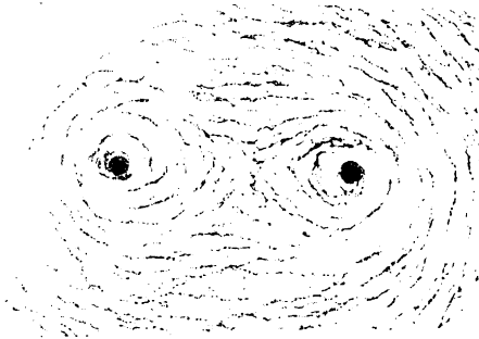
Bild 2b: Fotografie eines magnetischen Feldes zweier paralleler Leiter mit gleicher Stromrichtung
