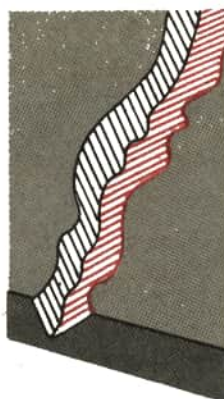
15.1 Schriftarten bei der mechanischen Schallspeicherung a) Tiefenschrift, mit der Herr Edison seine Stanniolwalzen bespielte b) einfache Seitenschrift für Mono-Schallplatten c) 45°-Seitenschrift für Stereoschallplatten
