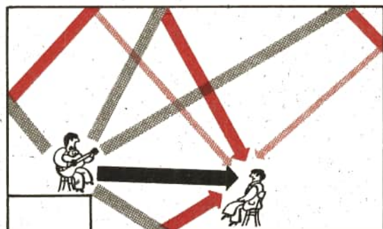
3.1 Direktschall und reflektierter Schall gelangen auf verschiedenen Wegen zum Zuhörer
