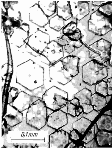
Bild 3.47. Orientierte Aufwachsung von Eis-(I) auf der Basisfläche von Bleijodid \text{PbJ}_2 (Kleber und Weis [3.30])
