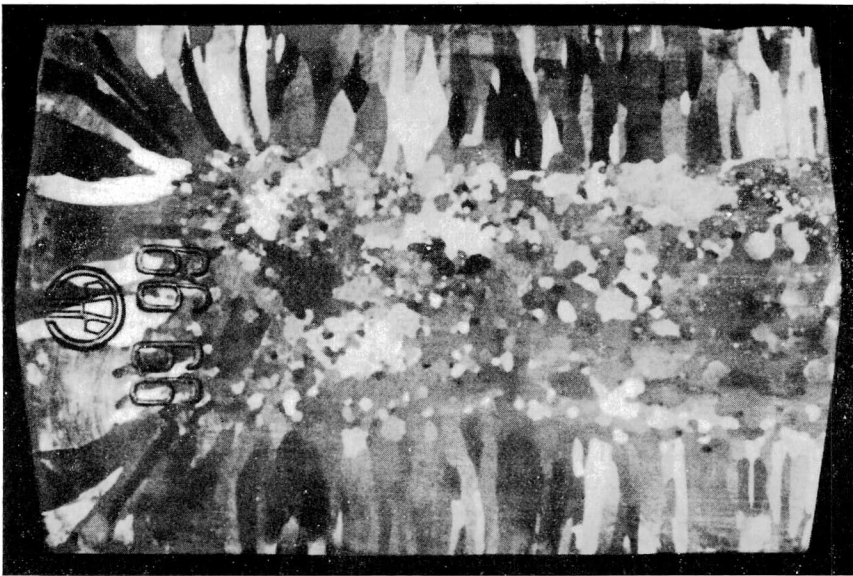
Bild 3. Angeschliffene und angeätzte Oberfläche eines Aluminiumgußstückes
