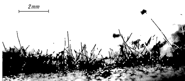
Bild 3.41. Whiskers aus \alpha -Eisen, hergestellt durch Reduktion von Eisenbromid \text{FeBr}_2 bei 720^\circ\text{C} (Sears und Brenner [3.22])
