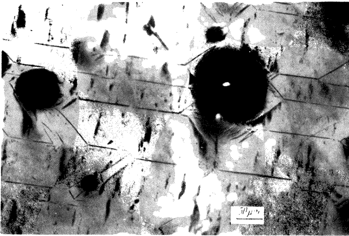
Bild 4.12. Ferromagnetische Domänen auf einer (100)-Fläche eines Einkristalls aus Eisen-Silicium
