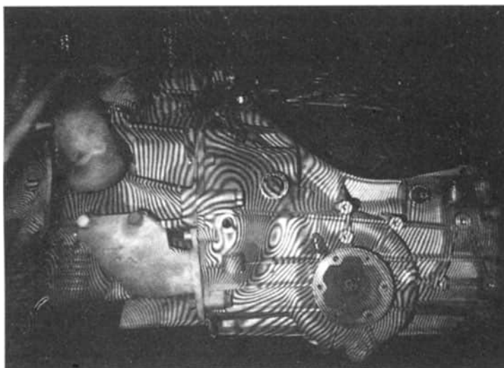
Abb. 114. Schwingungsverteilung auf einem Getriebegehäuse bei 6200 U/min
