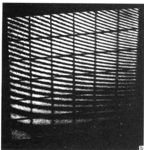
Abb. 90. Holografische Interferogramme einer gedehnten elastischen Platte, die aus unterschiedlichen Gebieten des Hologramms rekonstruiert wurden
