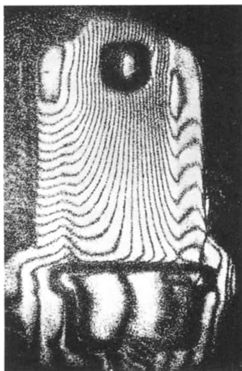
Abb. 119. Holografisch erzeugte Konturlinien gleicher Höhe nach der Zwei-Wellenlängenmethode
