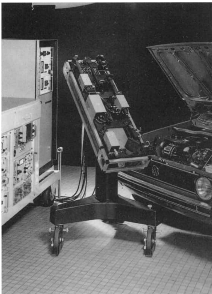
Abb. 113. Doppelpuls-Hologrammkamera PHK 1 von VOLKSWAGEN mit Energieversorgung und Triggervorrichtung
