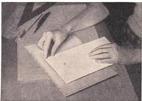
Bild 542. Schnitt für jeden kegelförmigen Lampenschirm
