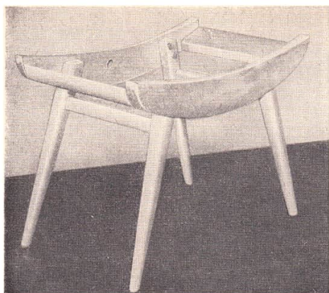
Bild 202. Polstergestell für einen Gondelhocker
