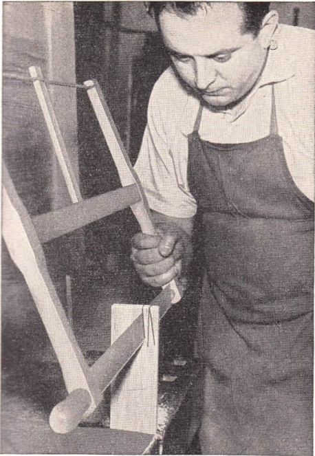
Bild 106. Grundprinzipien der Keilverbindung im parallelwängigen oder konischen Zapfenloch
