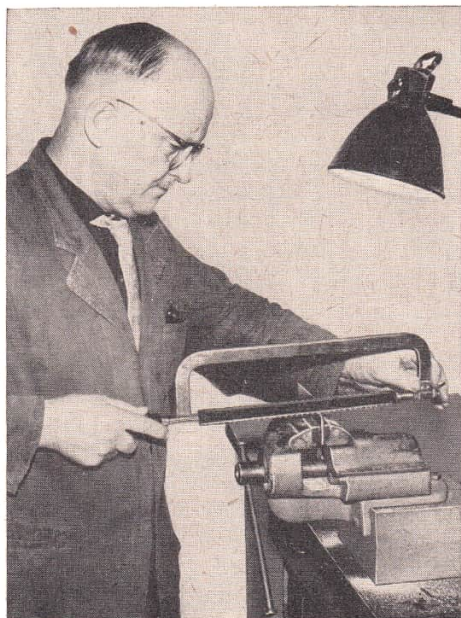
Bild 337. Vorschriftsmäßige Körperhaltung beim Arbeiten mit der Säge
