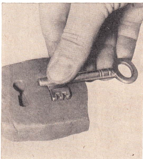
Bild 372. Wenn nach einem vorhandenen Schlüssel ein weiterer gefeilt werden soll, dann nimmt man vorteilhafterweise Knetmasse zu Hilfe
