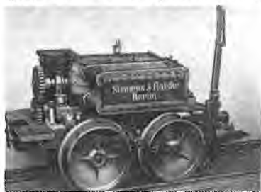
elektrisches Triebfahrzeug: erste elektrische Lokomotive, Baujahr 1879
