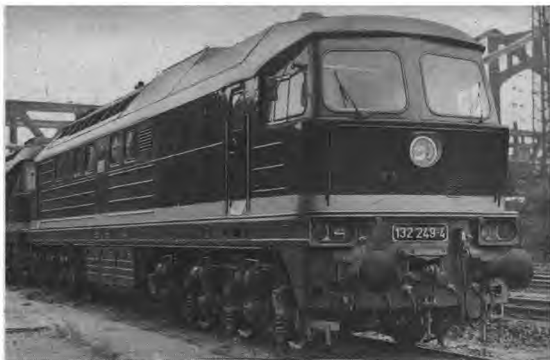
dieselelektrische Lokomotive der Baureihe 132 für den schweren Schnellzug- und Güterzugdienst, erstes Baujahr 1973
