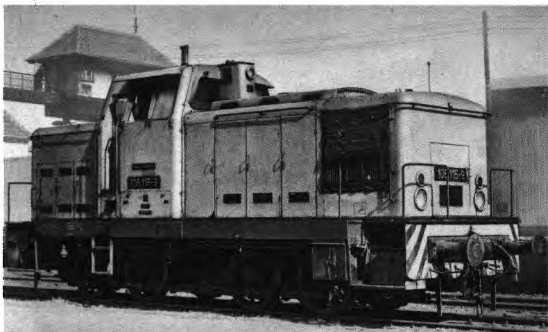
Rangierdiesellokomotive der Baureihe 106 der Deutschen Reichsbahn, erstes Baujahr 1961
