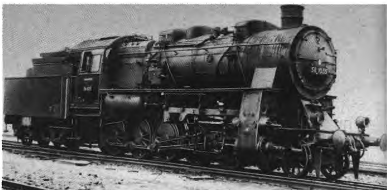
Güterzuglokomotive der Baureihe 58 (erste Einheitslokomotive, Gattung G12), Baujahr 1917
