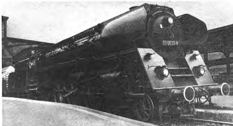
Heißdampf-Schnellzuglokomotive (Reko-Lok) der Baureihe 01, Reko-Jahr 1962
