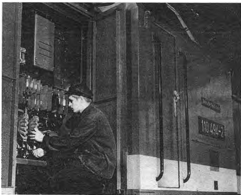
Elektromonteur bei Instandsetzungsarbeiten an der elektrischen Anlage einer Diesellokomotive
