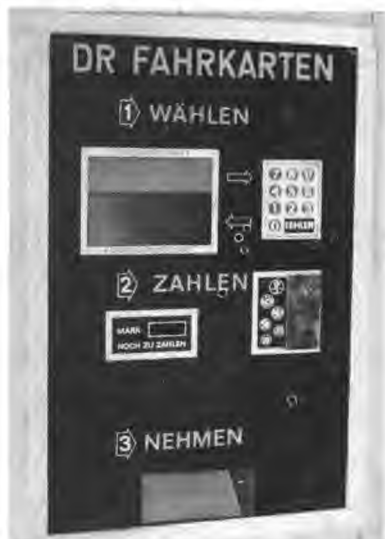
Fahrkartenausgabe: mikrorechnergesteuerter Fahrkartenverkaufsautomat (»Dialogautomat«)
