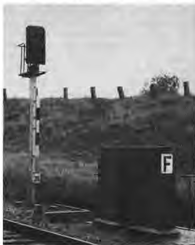
Automatischer Streckenblock: automatisches Blocksignal mit Relais- und Fernsprechrückmeldung an einem Streckengleis
