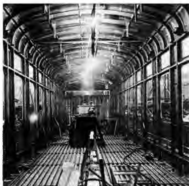
Schienenfahrzeugbau: geschweißter Wagenkasten eines Reisezugwagens
