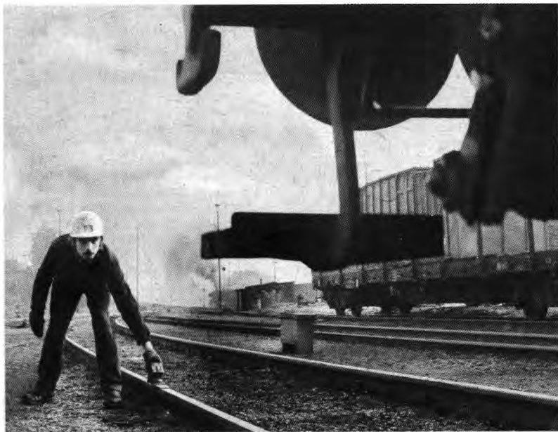
Zum Rangierpersonal gehört der Rangierer; hier beim Auflegen eines Hemmschuhs
