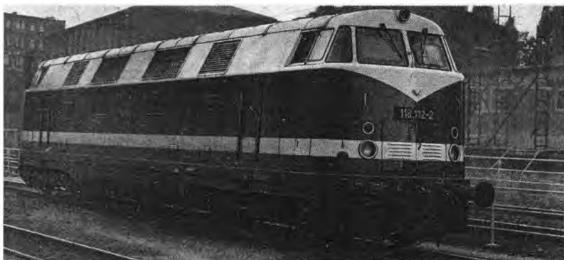
dieselhydraulische Lokomotive der Baureihe 118 für den Schnellzug- und Güterzugdienst, erstes Baujahr 1962
