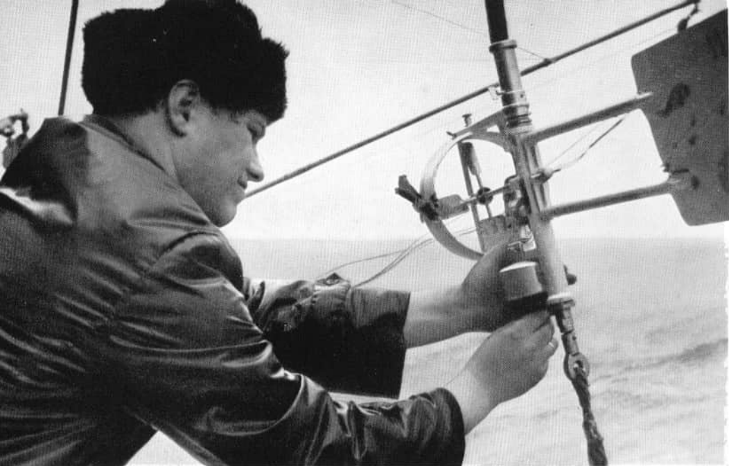
Vorbereitung des „Ekman-Merz“ zur Strömungsmessung. Unsere Ozeanographen notieren den „Drahtwinkel“. – Der selbstregistrierende Strömungsmesser (rechts)
