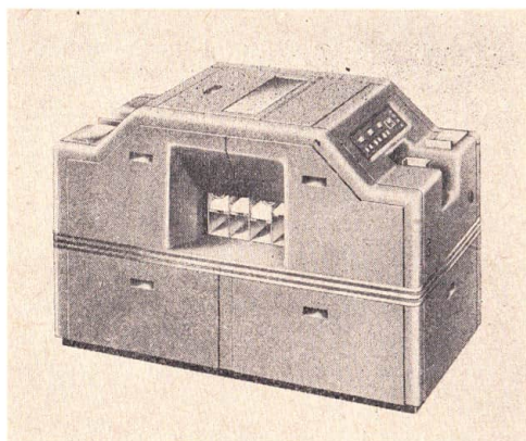
Bild 76 Mischdupliziermaschine (Mischdupliziermaschine Aritma 720)
