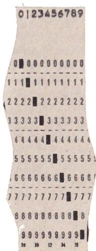
Bild 45 Zifferncode einer 80spaltigen Lochkarte
