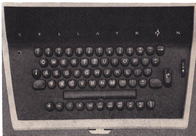
Bild 88 Tastatur einer elektrischen Schreibmaschine mit angeschlossenem Lochbandlocher (Cellatron SE 5L mit Lochbandcode)
