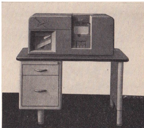
Bild 67 Schrittweise druckender Lochschriftübersetzer (80spaltig) als Tischgerät (Lochschriftübersetzer Bull 36.00)
