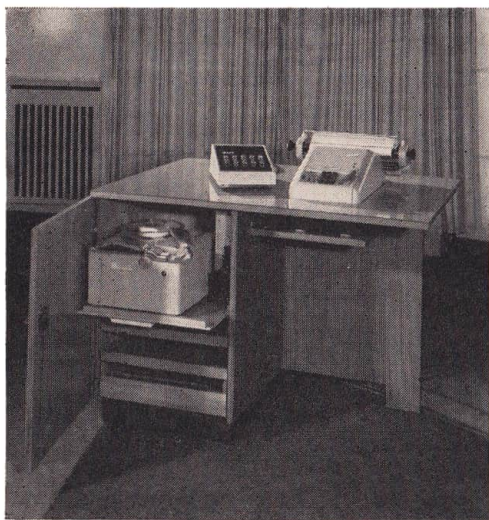
Bild 97 Kleinbuchungsmaschine mit angeschlossenem Bandlocher (Kleinbuchungsautomat Ascota 117 Ls)
