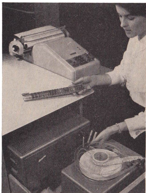
Bild 91 Programmelemente einer Buchungsmaschine mit angeschlossenem Bandlocher (Buchungsmaschine Ascota 117 Ls)
