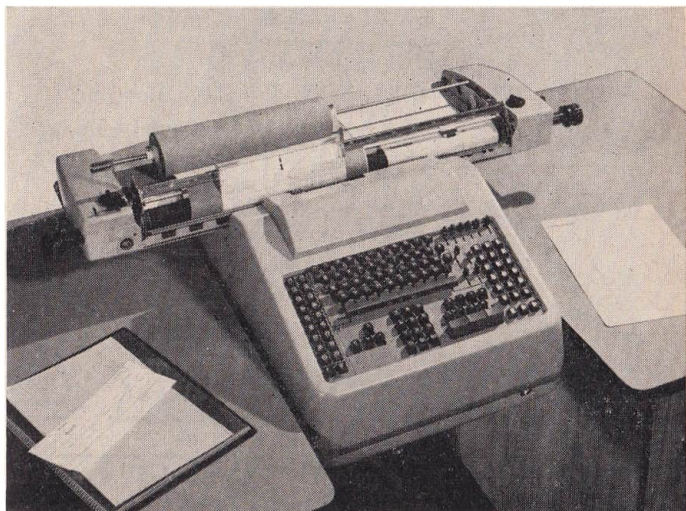
Bild 11 Buchungsmaschine mit 55 Zählwerken (Buchungsautomat Ascota 170/55)
