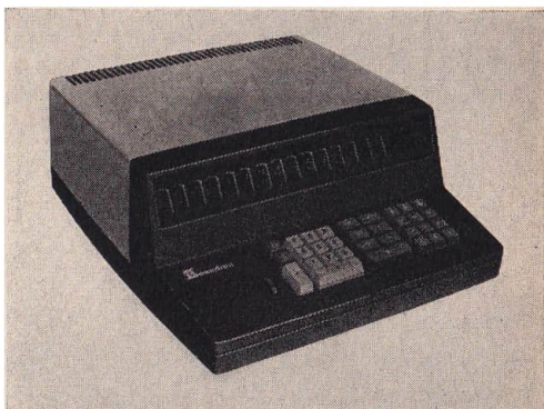
Bild 9 Elektronischer Tischrechner (Soemtrom 220)
