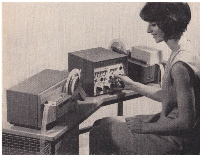
Bild 103 Lochband-Dupliziergerät (Lochstreifendoppler Facit PE 1300)
