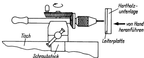
Bild 5.2 So setzt man die Handbohrmaschine bei Leiterplatten ein
