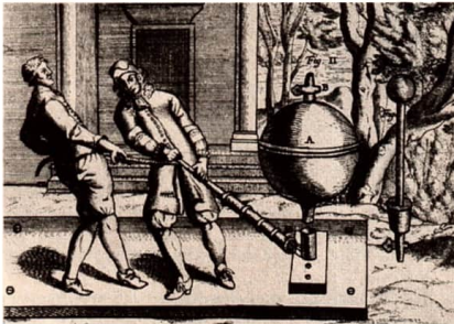
Abb. 2.5.5./1 Guerickes Experiment zum Auspumpen einer Kupferkugel
