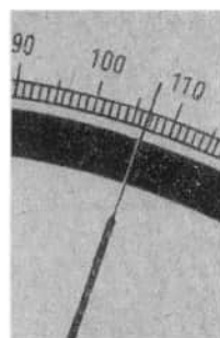
Bild 8. Der Zeiger erscheint als Strich, wenn man senkrecht zur Skale blickt; es tritt kein Parallaxenfehler auf.
