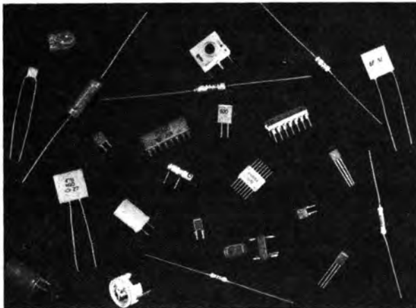
Bild 2.6 Solche Bauelemente sind heute «leiterplattenüblich». Viele tragen Anschlüsse in nur 2,5 mm Abstand
