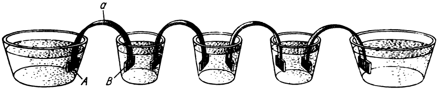
Voltas Becherapparat, eine Reihenschaltung galvanischer Elemente A, B verschiedene Metalle, z. B. Kupfer und Zink; a metallische Verbindungen zwischen den Elementen
