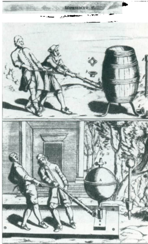
Otto von Guericke (1602 bis 1686) Pumpversuche mit dem Weinfaß und der kupfernen Kugel
