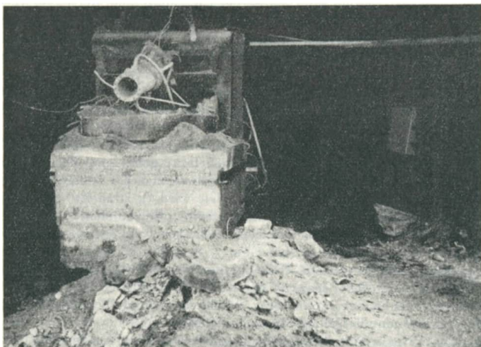
Bild 2.2 Durch Wasserstoffsuperoxyd-Explosion zerstörter Prüfstand (SEPR)
