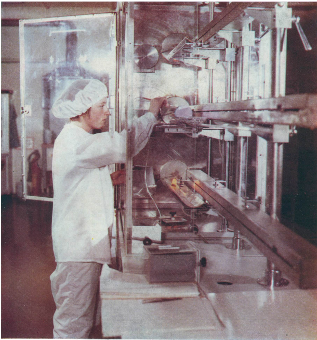
Abb. 42 Arbeit im Reinraum: Beschickung eines Diffusionsofens mit Siliziumscheiben
