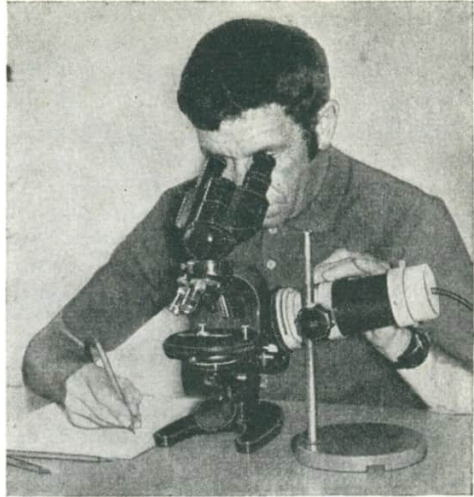
Abb. 53/1 Geräteanordnung zur Herstellung behelfsmäßiger Auflicht-Dunkelfeld-Beleuchtung
