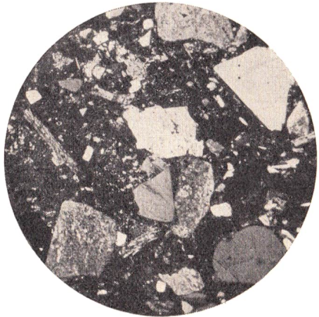
Abb. 7b. Dünnschliff eines Quarzporphyrs (Ergußgestein). Einsprenglinge in überwiegend feinkörniger Grundmasse (25fache Vergrößerung)
