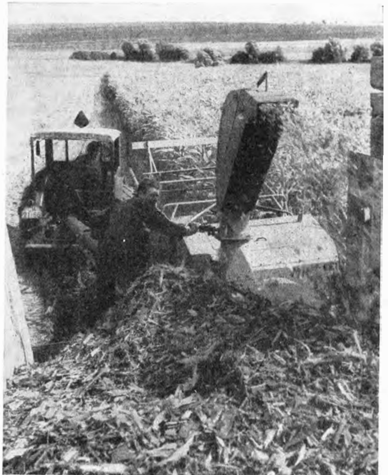
Auftakt zur Maisernte im Kreis Prenzlau. Der Mähhäcksler E 065 vom VEB „Fortschritt“, Neustadt, im Einsatz
