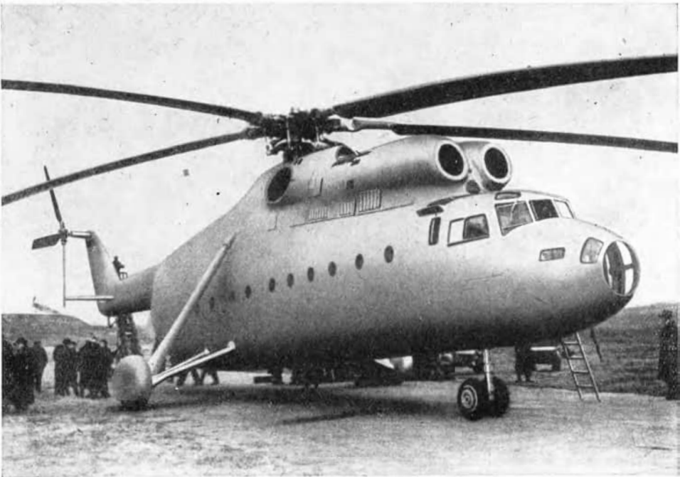
Bild 8. Der sowjetische Hubschrauber vom Typ Mi 6 wird mit zwei Turbopropaggregaten angetrieben. Im November 1957 erreichte er die neue Rekordhöhe von 2400 m bei einer Belastung von 12000 kg. In ihm finden 80 Passagiere Platz. Der Mi 6 ist doppelt so groß wie der amerikanische Hubschrauber vom Typ S 56
