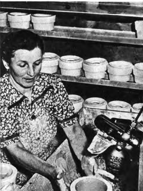
Alte und neue Technik beim Becherdrehen. Früher wurde die Schablone mit der Hand geführt, jetzt wird die gleiche Arbeit mit Becherautomaten schneller, bequemer und besser ausgeführt
