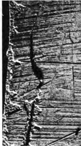
▲ Schnitt durch den am Tatort und den am Wagen gesicherten Lacksplitter. Übereinstimmung der Farbbindemittelschichten
