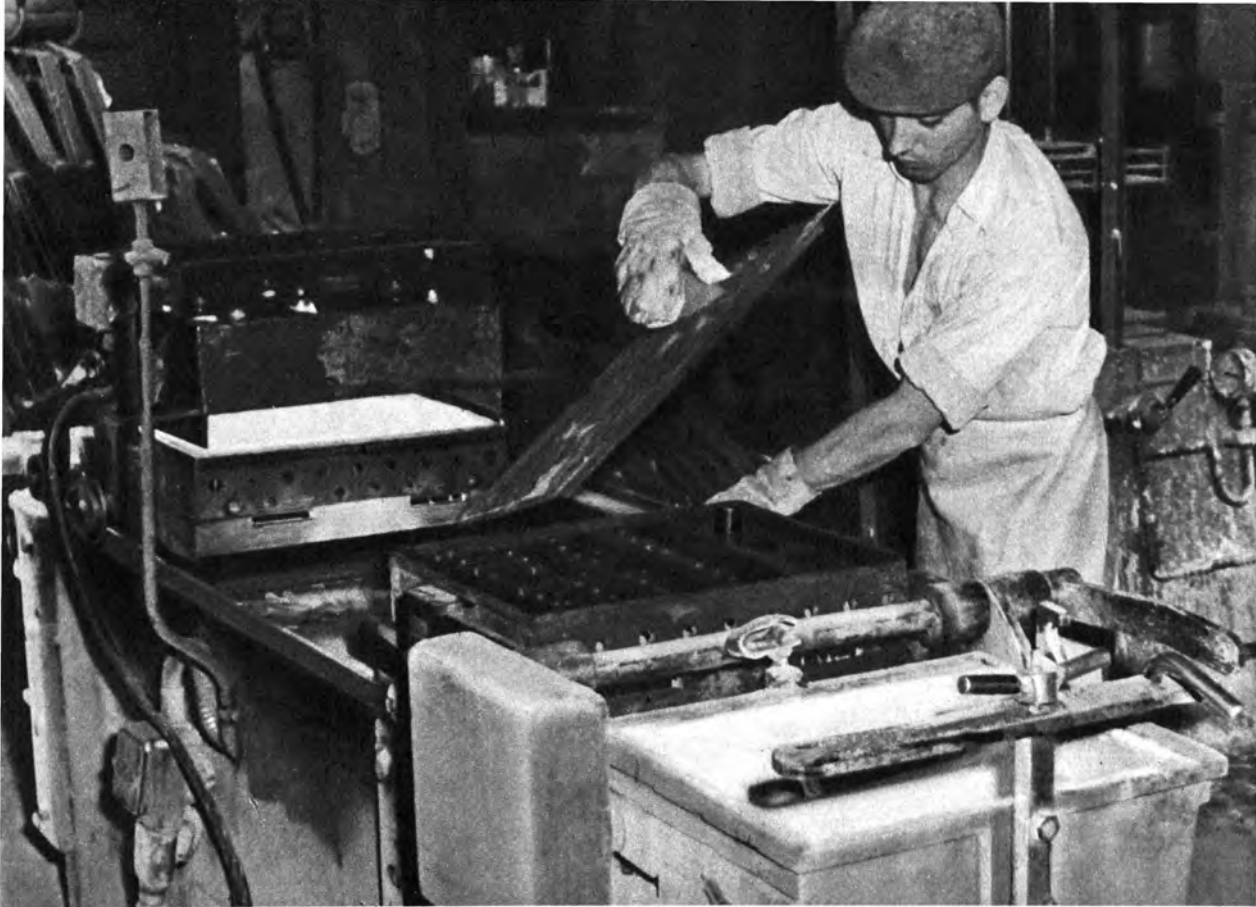
Auf dem Hainsterger Kipper wird die Formmaske für den Nähmaschinenarm aus einem Quarzsandgemisch über Gaserbitzern und unter Infrarotstrahlern hergestellt
