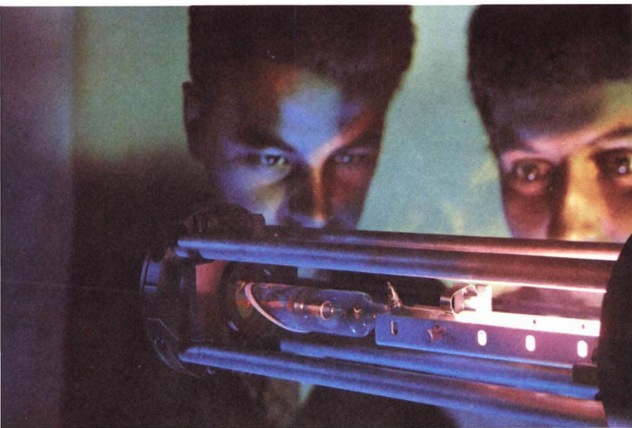
Gaslaser ZGL 300 mit einer Ausgangsleistung von 0,3 mW bei 0,633 \mu\text{m}
