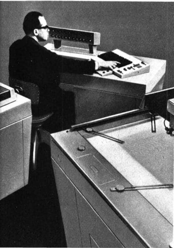
Cartimat III zum Aufzeichnen beliebiger mathematischer Funktionen nach vorangehender Datenverarbeitung
