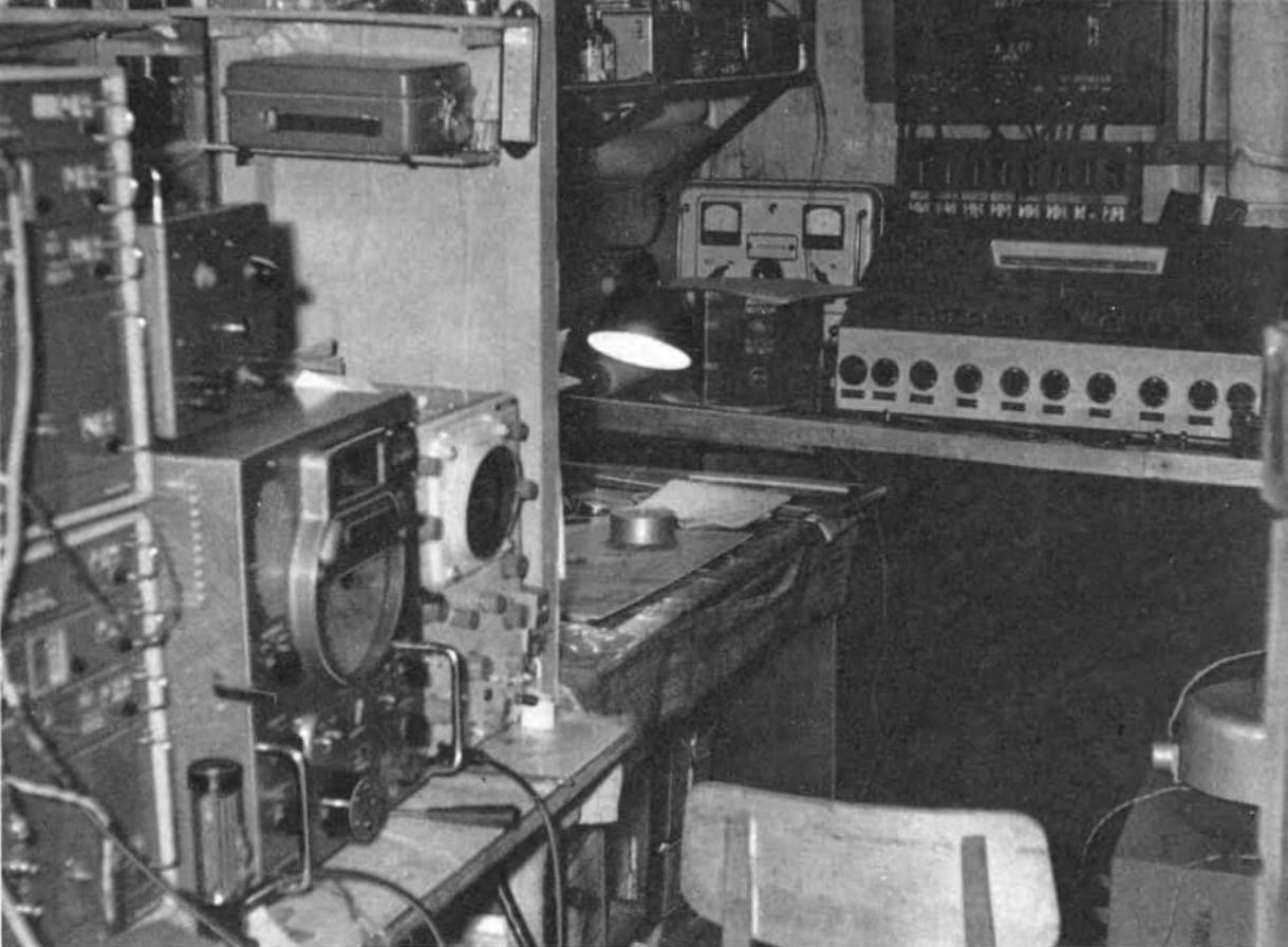
Blick in den geophysikalischen Arbeitsraum. V. l. n. r.: Quarzuhr und Zeitzeichenempfänger, Steuerpult für die erdmagnetischen Meßeinrichtungen
