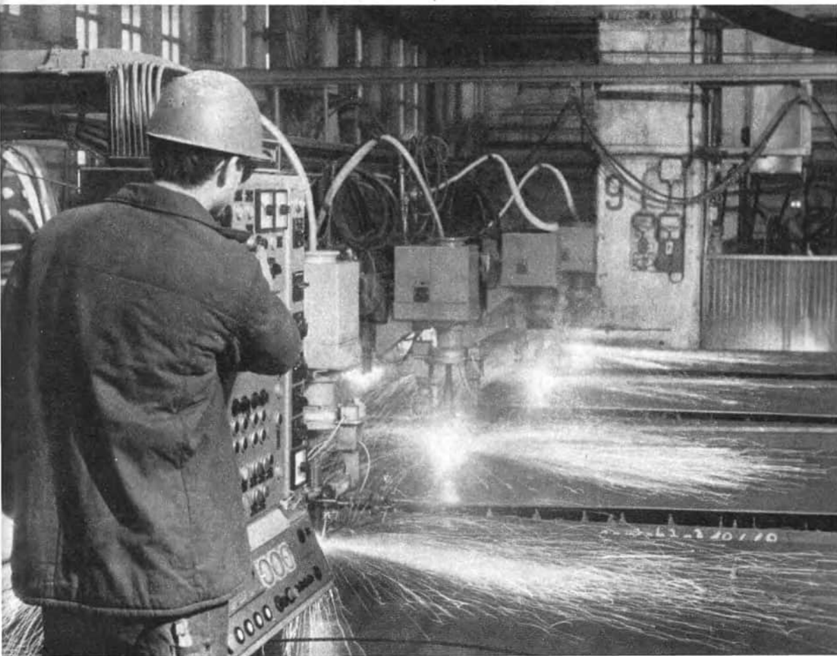
Plasma-Brennschneidmaschinen für den Zuschnitt von Schiffsplatten in der Volkswerft Stralsund
