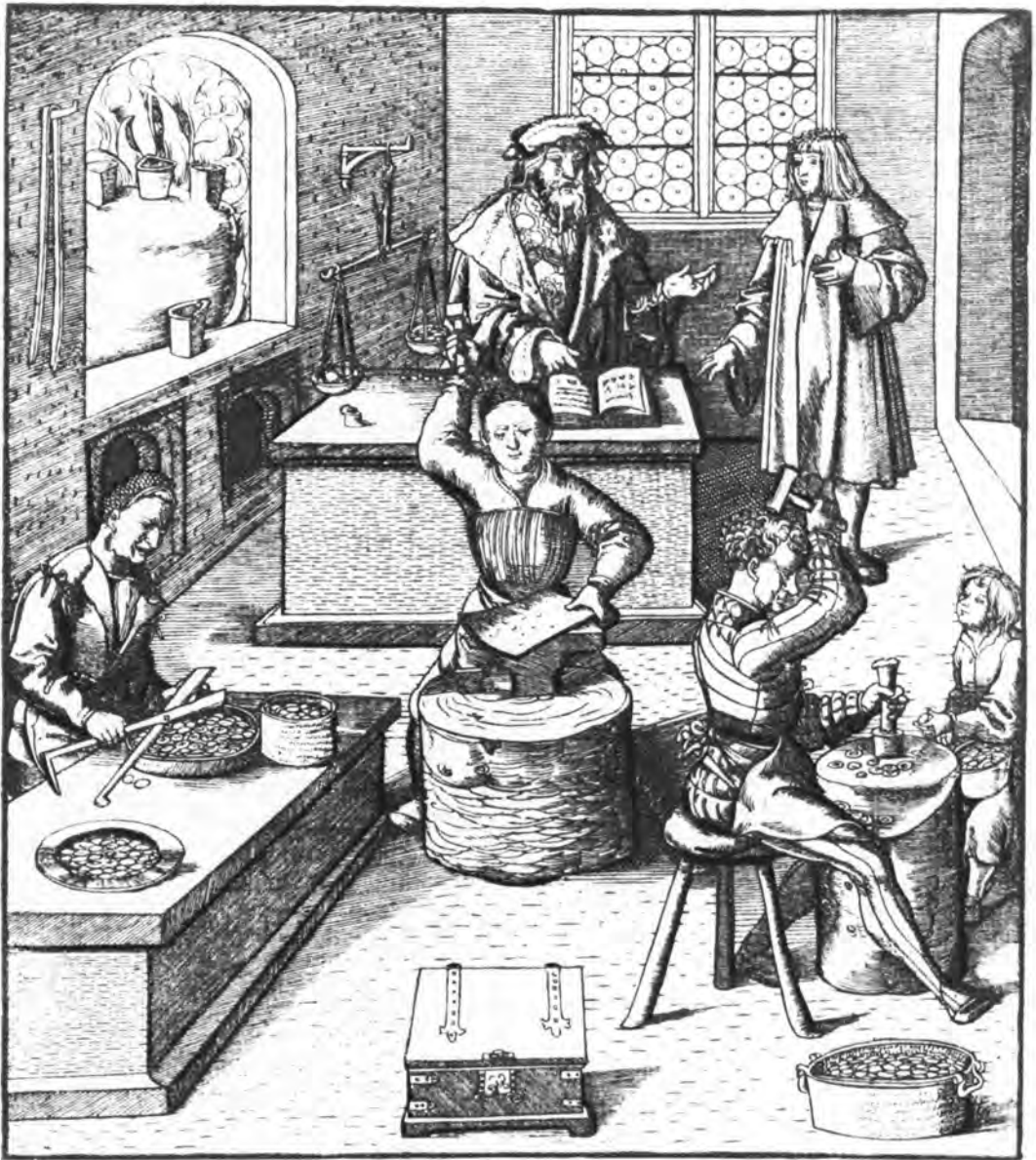
Kaiser Maximilian I. (1493–1519) besucht eine Münzwerkstatt. Der Münzmeister im Hintergrund erklärt ihm die technischen Vorgänge: die Herstellung des Metallbleches (Mitte), das Schneiden der runden Metallplättchen (links) und das Prägen mit Ober- und Unterstempel (rechts). Holzschnitt aus dem „Weiskunig“; der Leonhard Beck (1480–1542) zugeschrieben wird
