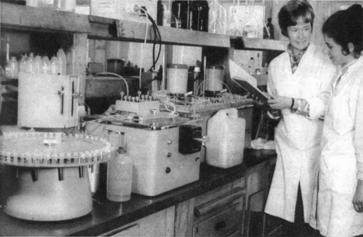
Fließautomat des Kombinats Medizin- und Labortechnik, Dresden, zur Bestimmung von Kreatinin im Blutserum
