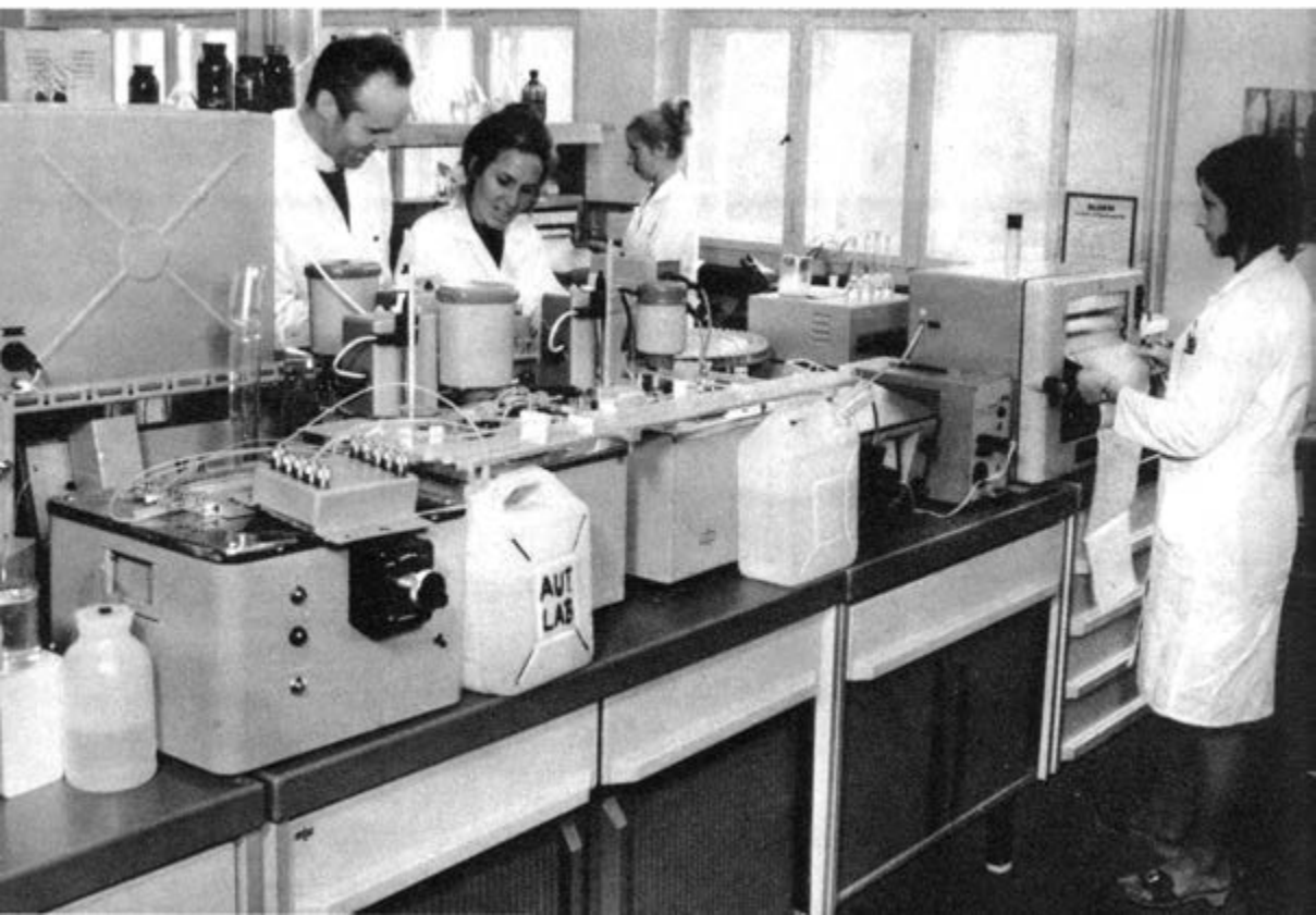
Blick in das Zentrale Automatenlaboratorium in Leipzig. Im Vordergrund 2 Fließsysteme des Kombinati Medizin-und Labortechnik, Dresden, für die Bestimmung von Butanol-extrahierbarem Jod und von Eisen im Blutserum
