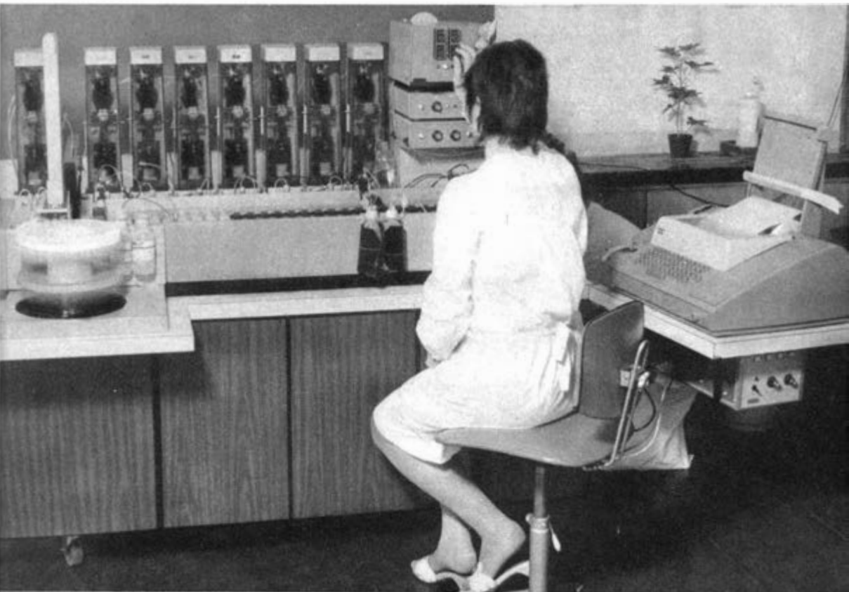
Zweikanal-Automat zur diskontinuierlichen Bestimmung einiger Parameter im Blutserum
