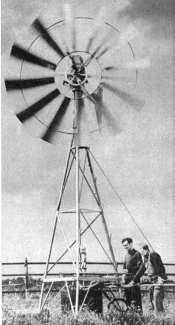
Wind pumpt Wasser: Moskauer Techniker entwickelten diese elektrische Pumpvorrichtung, deren Energie der Wind liefert
