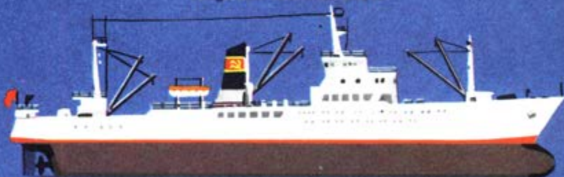
Supertrawler Typ »Horizont« Länge über alles 112,80 m
