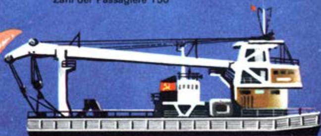
Schwimmkran Tragkraft 300 Mp Länge über alles 54,70 m
