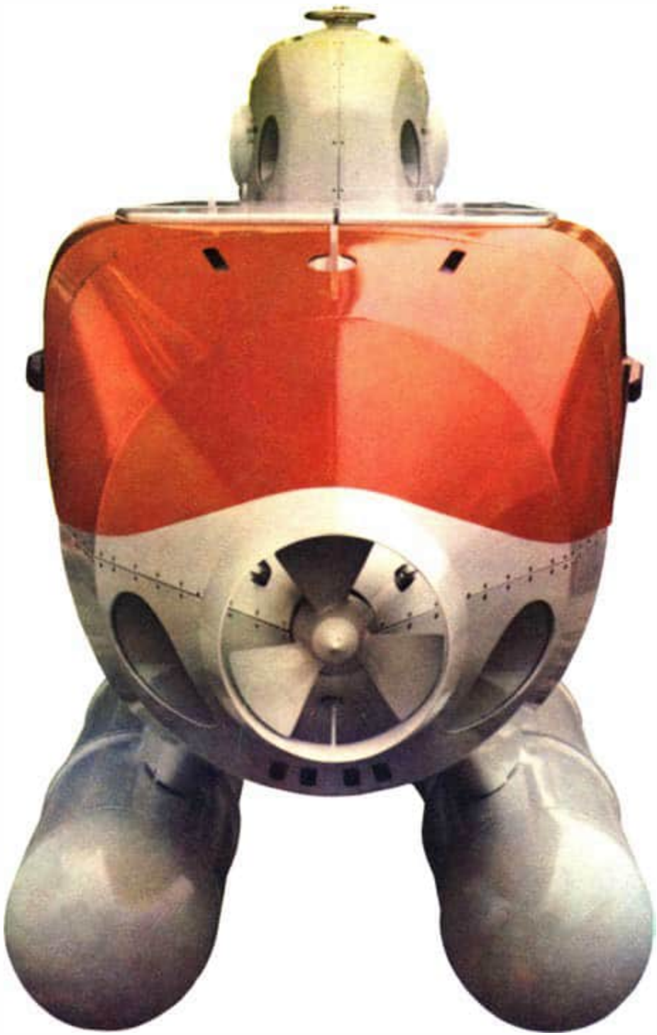
Die »Mermaid« – ein Arbeitstauchboot für allgemeine meeresbiologische Forschungen und spezielle Unterwasserarbeiten an unterseeischen Produktionsanlagen
