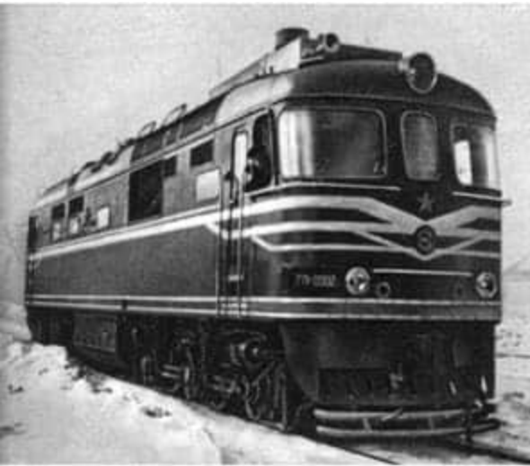
Gasturbinenlokomotive der sowjetischen Staatsbahnen für den Reisezugdienst
