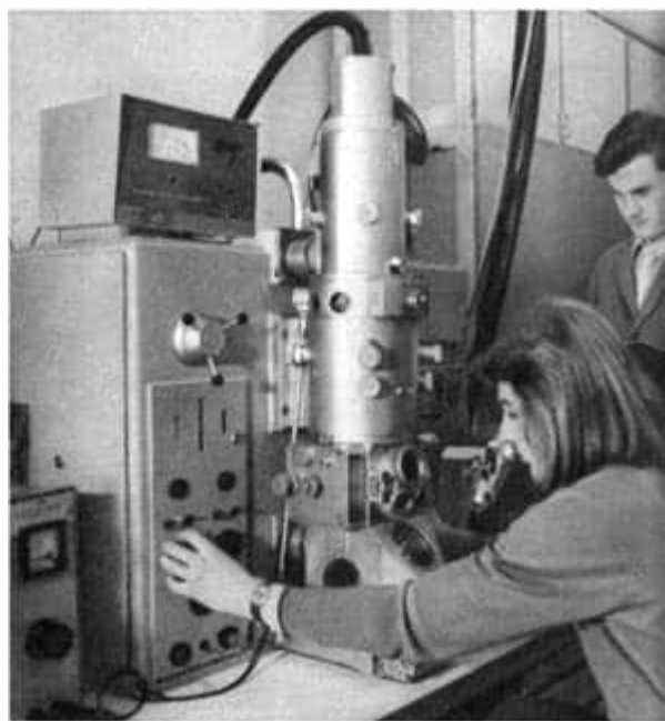
Mitarbeiter der Sektion Physik/Elektronische Bauelemente der TH Karl-Marx-Stadt bei Untersuchungen von dünnen Schichten mit dem Elektronenmikroskop EF 4 vom VEB Carl Zeiss JENA
