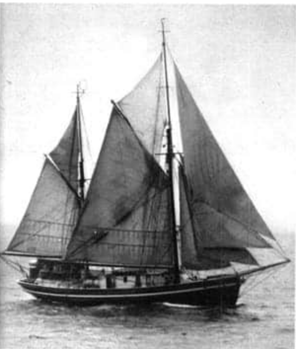
Die Ketsch »Seute Deern« (BRD) dient als Schulschiff für die Handelsmarine und als Segler für touristische Kreuzfahrten. Länge 36,20 m, Breite 7,15 m, Tiefgang 3,50 m, Segelfläche 275 m 2
