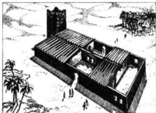
Sonnenkollektorendach zur Speisung einer Bewässerungsanlage mit Dampf zum Pumpenbetrieb
