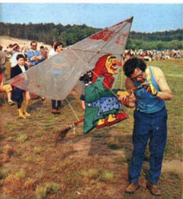
Etwas zur Belustigung der Zuschauer: eine fliegende Brockenhexe, ausgerüstet mit einem 2,5 cm 3 -Glühkerzenmotor und Ragalloflügeln
