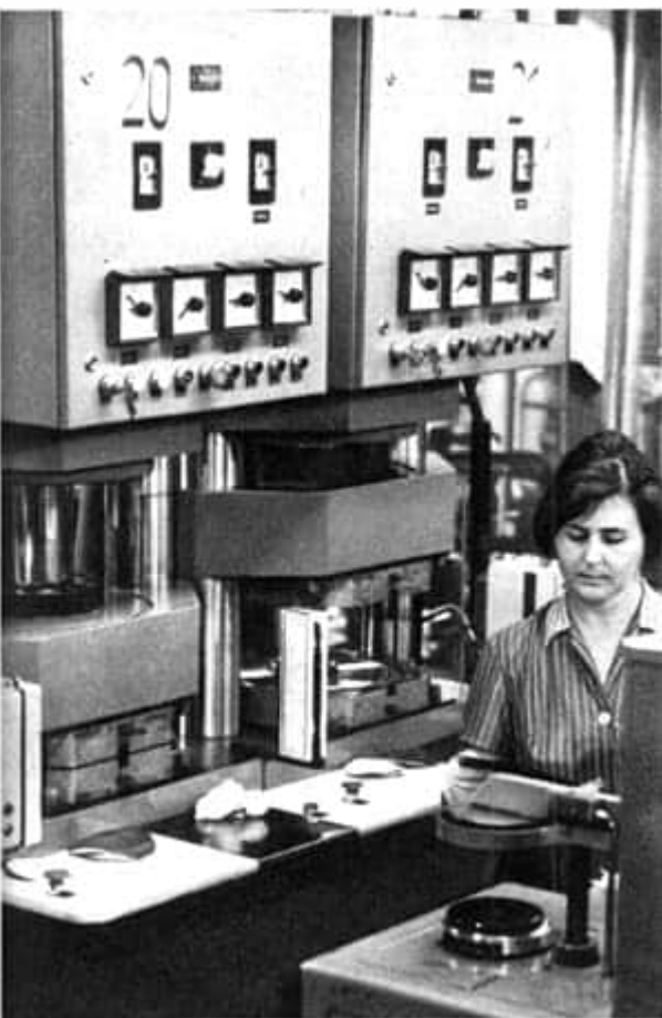
Links: handbediente Doppelpresse; im Vordergrund Vorplastifizierungsgerät mit Massekloß Rechts: moderne Vollautomaten im Schallplattenpreßwerk
