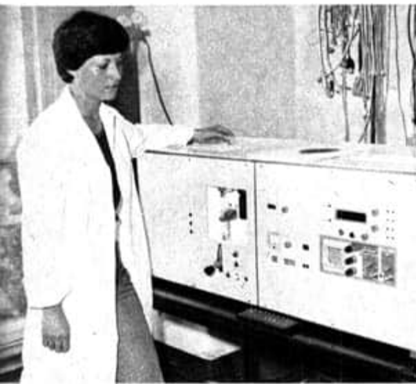
Der vom Zentralinstitut für Isotopen- und Strahlenforschung entwickelte und gehaute Stickstoff-15-Analysator NOI-6
