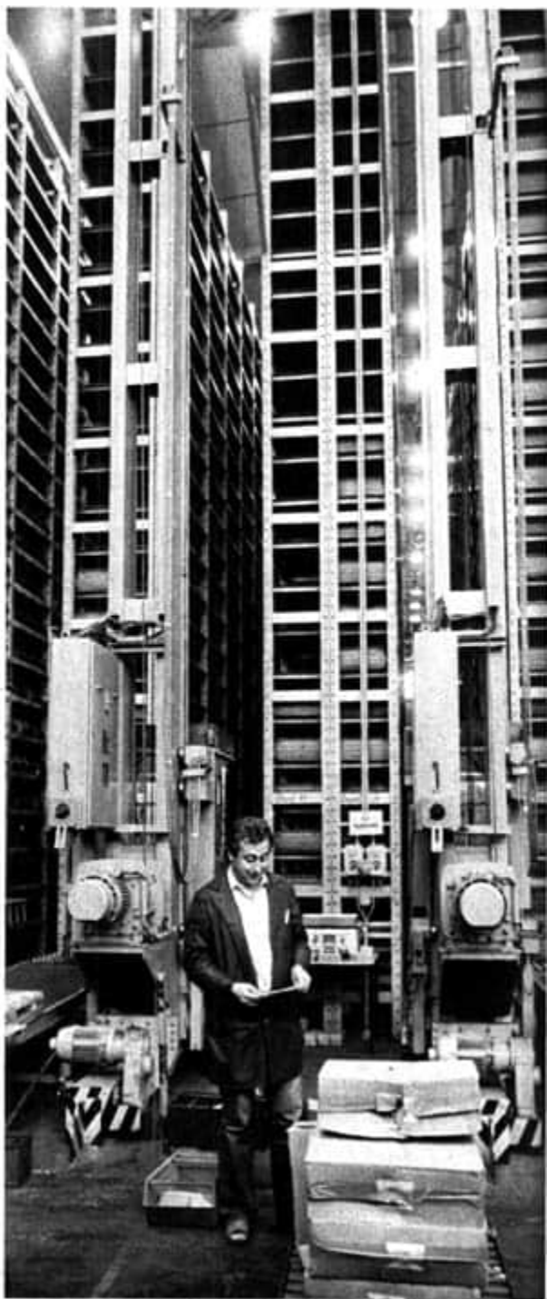
Ausgangspunkt einer automatisierten Transportkette: ein Hochregallager mit rund 50000 Stellflächen; Ein- und Auslagerung sowie Bestandskontrollen erfolgen mit Hilfe der EDV-Technik
