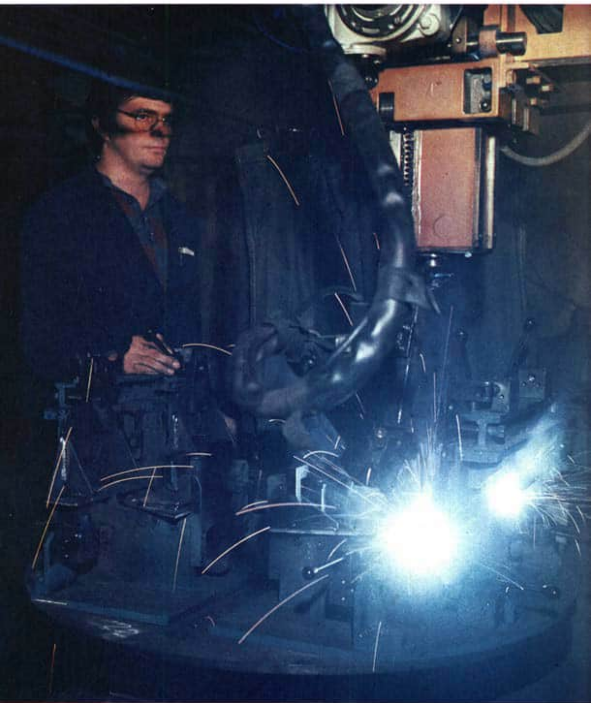
Der erste, im Zentralinstitut für Schweißtechnik (ZIS) Halle entwickelte Schweißroboter
