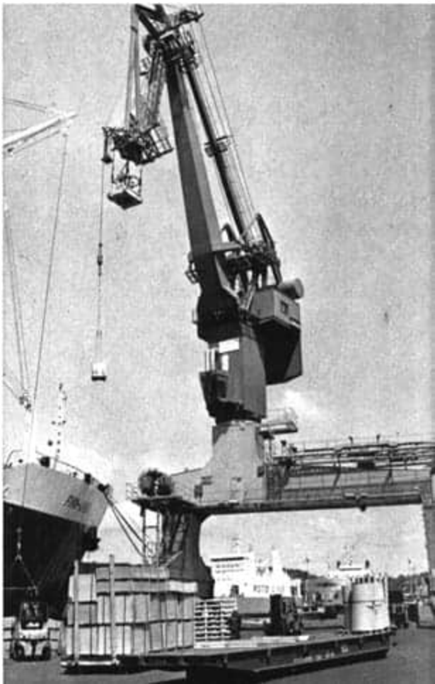
Universeller Doppellenken-Wippdrehkran mit Kranhaken und separater Containeranschlagmöglichkeit
