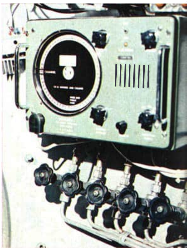
Vis-à-vis vom Piloten über dem Acrylglasbug: Echolot, links und rechts Tiefenmesser, darüber ein Digitalthermometer und das Hauptschaltpult. Unten: Die UKW-Sprechfunkanlage; sie läßt sich nur über Wasser betreiben
