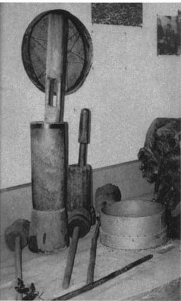
Im Paprika-Museum von Kalocsa: Mit diesen hölzernen Geräten wurden die getrockneten Gewürzpflanzen bis zu feinem Pulver verarbeitet
