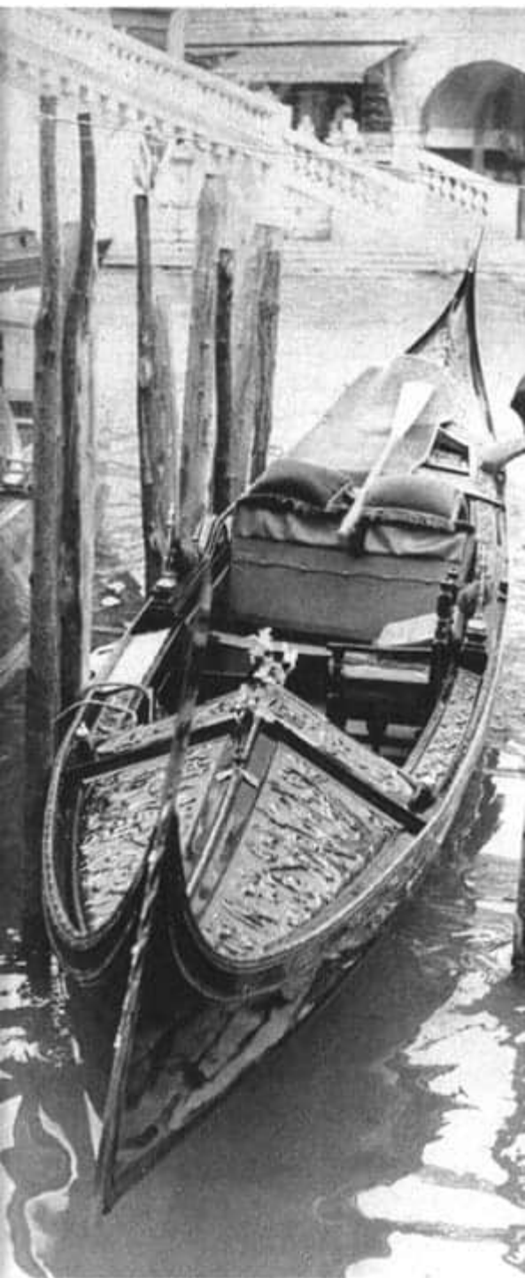
Das einmalige Gefährt einer einmaligen Stadt: die Gondel, die immer schräg im Wasser liegt, mit dem rohen Bugeisen, dem »Ferro«, wie vor hundert Jahren exakt 10m und 15 cm lang
