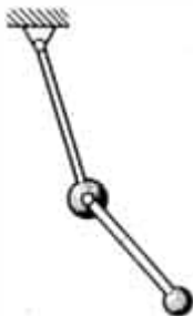
Bild 3: Ein Doppelpendel. Bei bestimmten Längen- und Massenverhältnissen ist die Bewegung chaotisch.
