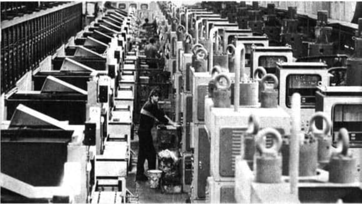
Keramische Werke Hermsdorf: In einem neuen, flexibel automatisierten Fertigungsabschnitt werden Bauelemente aus Ferrit – das sind Werkstoffe mit ferromagnetischen Eigenschaften – hergestellt
