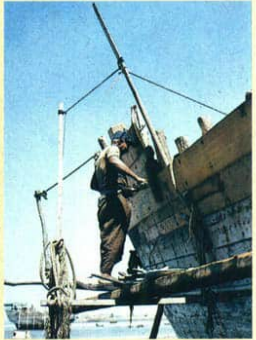
Ein Schiffszimmermann beim Gebrauch des traditionellen Drillbohrers; eine Planke wurde ausgewechselt
