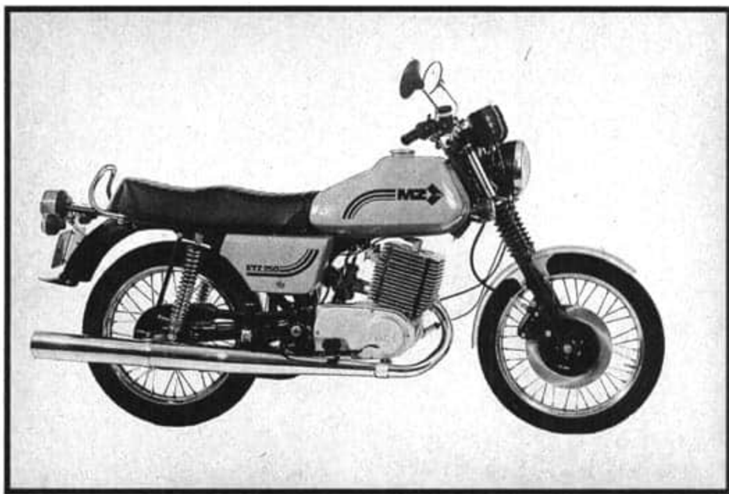
Die ETZ 250 wurde ab September 1981 in Produktion genommen. Neben einer markanten Linienführung erhielt das Motorrad einen optimierten Motor und wahlweise Scheibenbremse fürs Vorderrad
