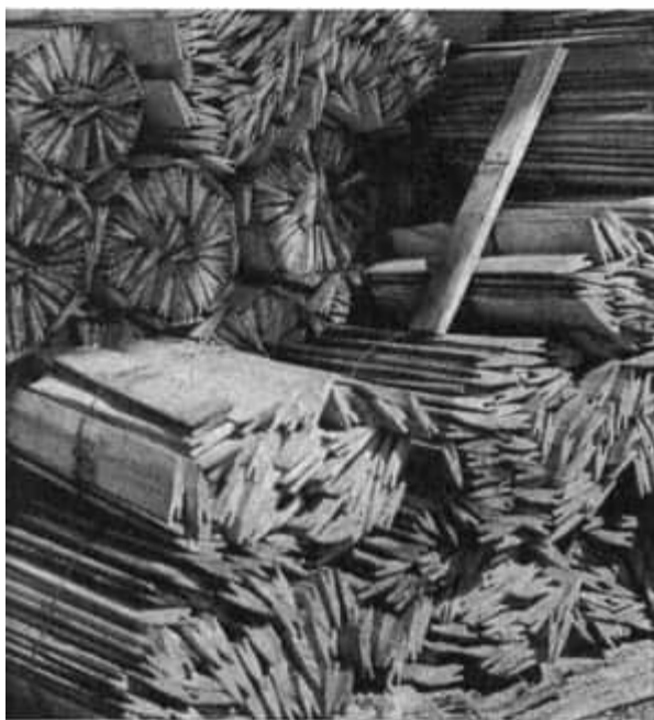
Bündel von Holzschindeln, die speziell für die Restaurierung alter Bauernarchitektur gefertigt werden
