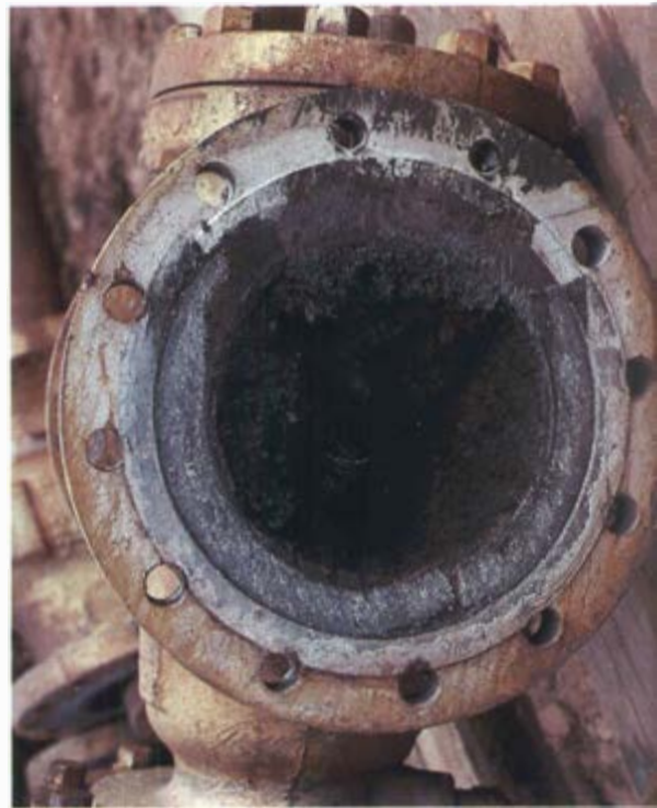
Salzgesättigte Lösungen aus der Tiefe haben einen Rohrquerschnitt zugesintert (Salton Sea, Kalifornien, USA)
