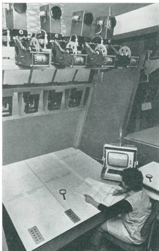
Auswerteplatz für Filmaufnahmen von Ereignissen in Blaskammern des Instituts für Hochenergiephysik der Akademie der Wissenschaften der DDR in Zeuthen bei Berlin
