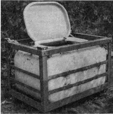
Abb. 3/6 Weichobstgroßbehälter T 922 E für den Transport von Sauerkirschen und Johannisbeeren
