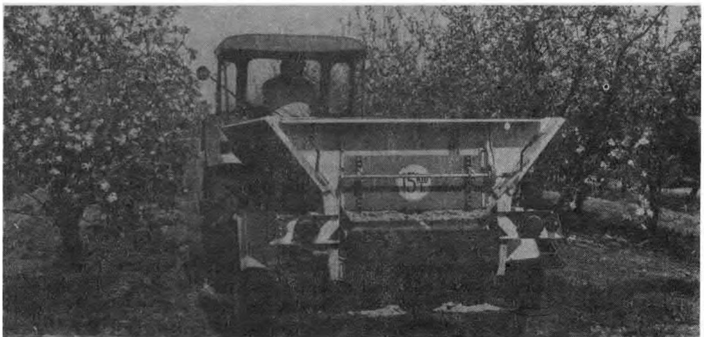
Abb. 4/9 Streuen von Mineraldünger mit dem Aufsattel-Mineraldüngerstreuer RCW 3
