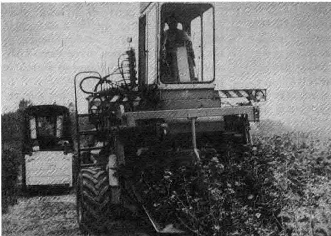
Abb. 3/7 Johannisbeererntemaschine E880 im Einsatz
