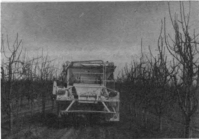
Abb. 3/2 W 50 mit Aufbau-Dün- gerstreuer IX) 32 beim Ausbringen der Grund- düngung
