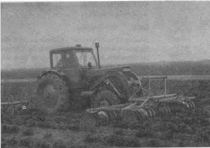
Abb. 6/5 Bodenbearbeitung mit Scheibeneggen zwischen den Erdbeerreihen zur mechanischen Unkrautbekämpfung
