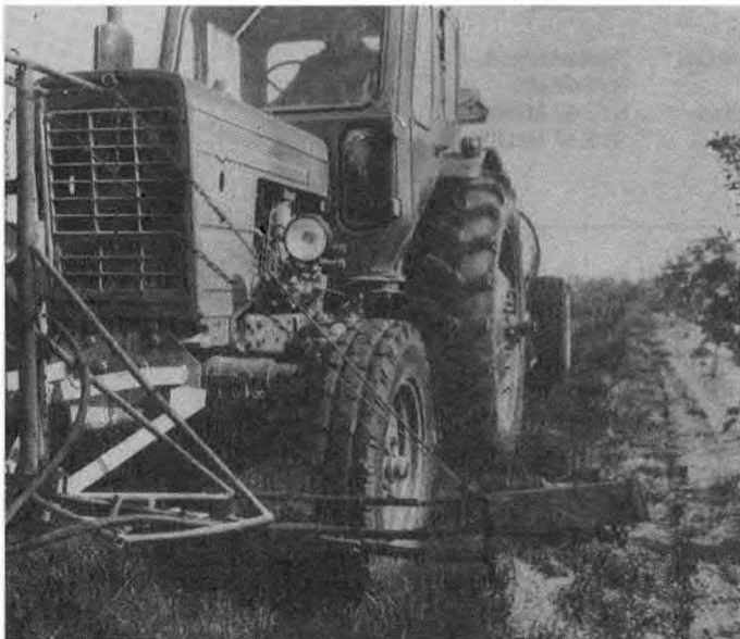
Abb. 4/8 Behandlung der Baumstreifen mit Herbiziden, MTS 50 mit seitlichem Spritzaggregat
