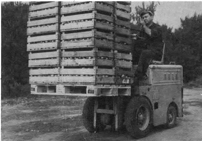
Abb. 3/4 Transportrationalisierung durch Einsatz des Ga- belstaplers
