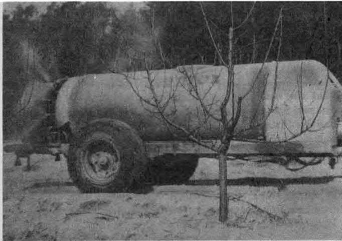
Abb. 4/20 Kertitox-Spritze, 2 000l-Brühebehälter, bei der Austriebsspritzung
