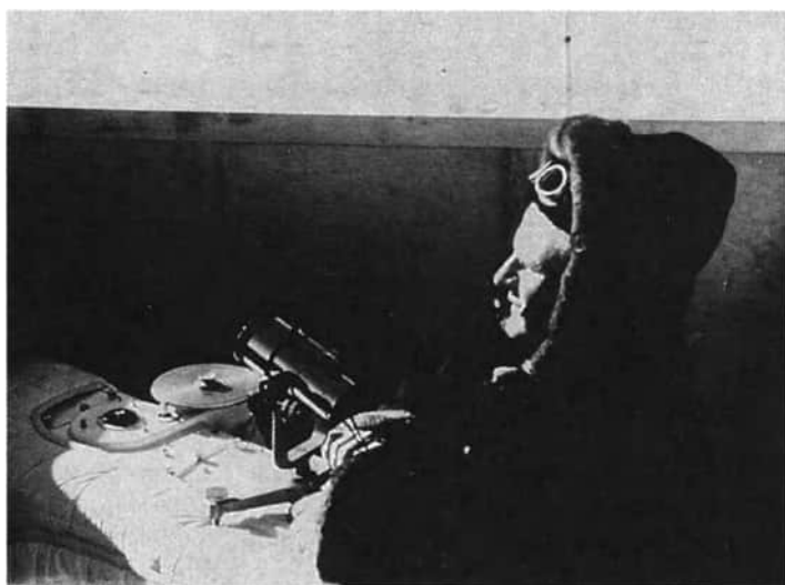
Abb. 51. Dr. Günter Skeib (DDR) mit dem Potsdamer Dobson-Spektrophotometer Nr. 71 an der Station Mirny während der V. Sowjetischen Antarktisexpedition von November 1959 bis April 1961. Auf dem Dobson-Spektrophotometer steht ein Pyrheliometer zur Messung der direkten Sonnenstrahlung
