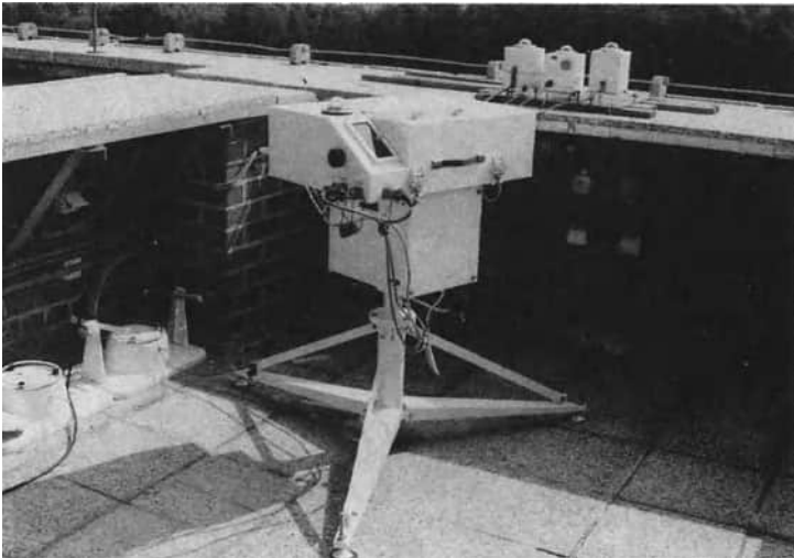
Abb. 64. Brewer-Spektrometer zur Messung der UVB-Strahlung der Sonne und des atmosphärischen Gesamtzongehaltes am Meteorologischen Hauptobservatorium Potsdam
