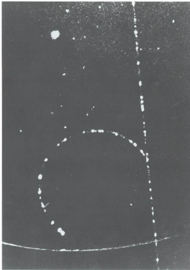
Ein schnelles Elektron trifft längs seiner Bahn auf ein Elektron. Das langsamere Sekundärelektron hinterläßt eine im Magnetfeld stark gekrümmte Spur in der Nebelkammer [4].
