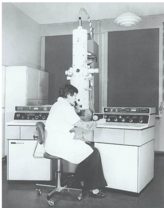
Das Elektronenmikroskop JEM 100 C (Joel) aus dem Institut für Festkörperphysik und Elektronenmikroskopie der AdW der DDR. Das mit einer Beschleunigungsspannung von 100 keV arbeitende Gerät besitzt ein Auflösungsvermögen von 3 \cdot 10^{-8} cm [6].
